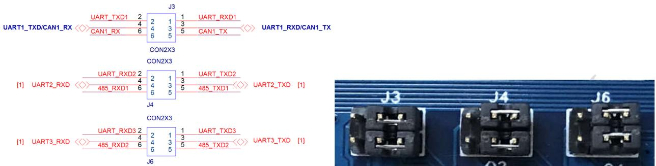
图 3-14.跳线原理及实物图
