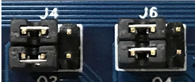
图 3-16 485 对应跳线方式示意图
